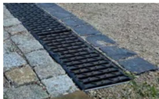
**MEA Guss-Stegroste (Belastungsklasse D 400) sorgen für sicheren Halt durch CLIPFIX-System mit Längsverschiebesicherung**
