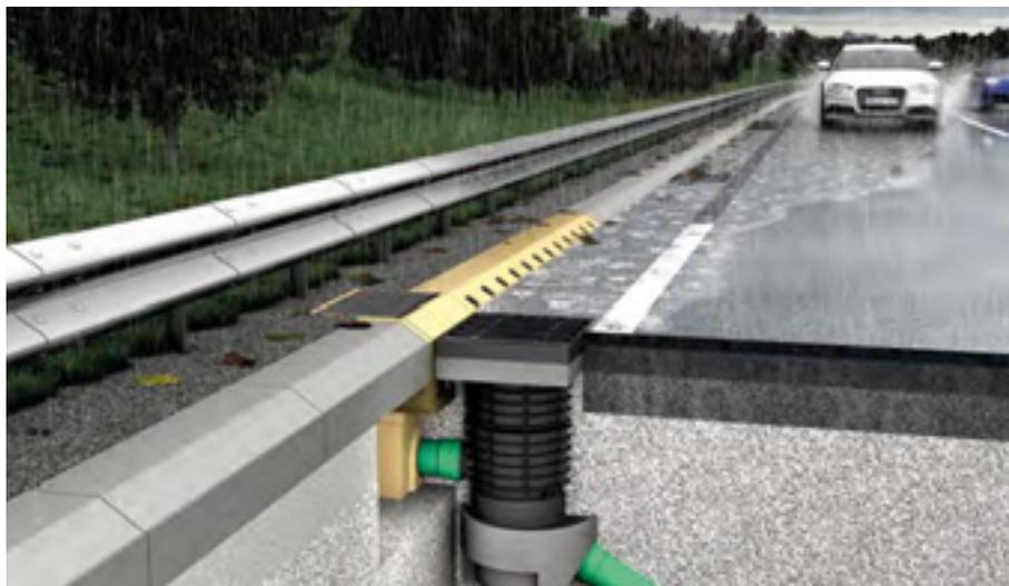
Einbausituation der ACO Drain®Box auf Autobahnen
