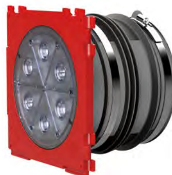
Einfach-Dichtpackung HSI150 KMA mit klappbarer Gummimanschette zum Einbetonieren und Anschluss von Kabelschutzschläuchen
