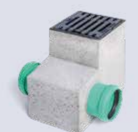
SAT002: Spezialablauf mit Trennsystem, E600 kN, 30x30x44 cm
