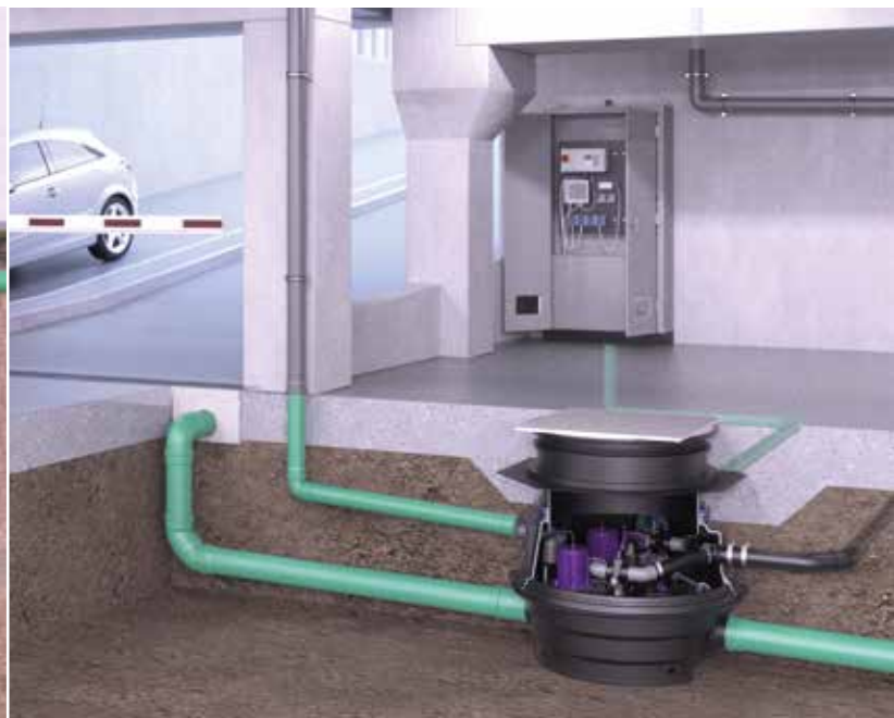
Einbaudarstellung Ecolift XL in einer Tiefgarage
