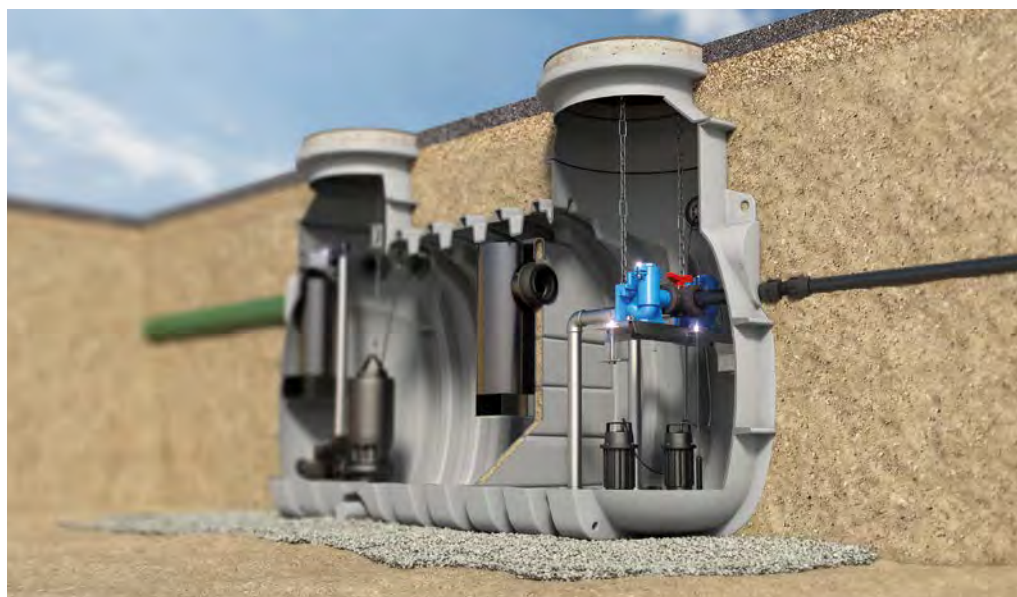
Die integrierte Pumpstation mit kombinierter Probenahmemöglichkeit dient zum Sammeln und automatischen Heben vom Abwasser über die Rückstauenebene – und somit auch zum Rückstauschutz
