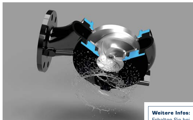
Das OC-Laufrad der Chopperpumpen-Baureihe Alligator beseitigt grobe Feststoff- und Faseranteile aus dem Abwasser
